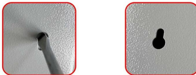
В случае дальнейшего использования прибора (после демонтажа заглушек верхних монтажных отверстий) с кронштейном, необходимо заклеить открытые монтажные отверстия в верней части задней стенки прибора непрозрачным скотчем. Это необходимо во избежание попадания свечения УФ лампы в глаза пользователя.
